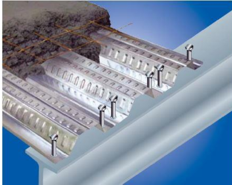
Figura 14. Sistema de losa con lámina colaborante.
