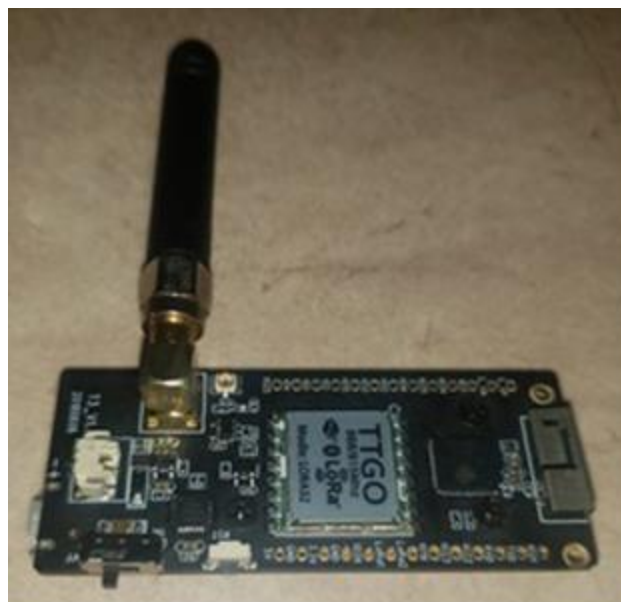
Figura 9. Modulo receptor, Tarjeta LoRa32 TTGO.
