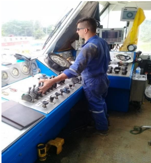
Figura 1. Puesto de trabajo del perforador.
