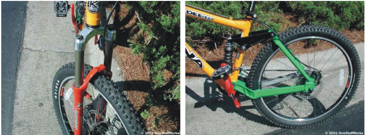
Imagen 2.29 sistemas de suspension a) sistema delantero b) sistema trasero
