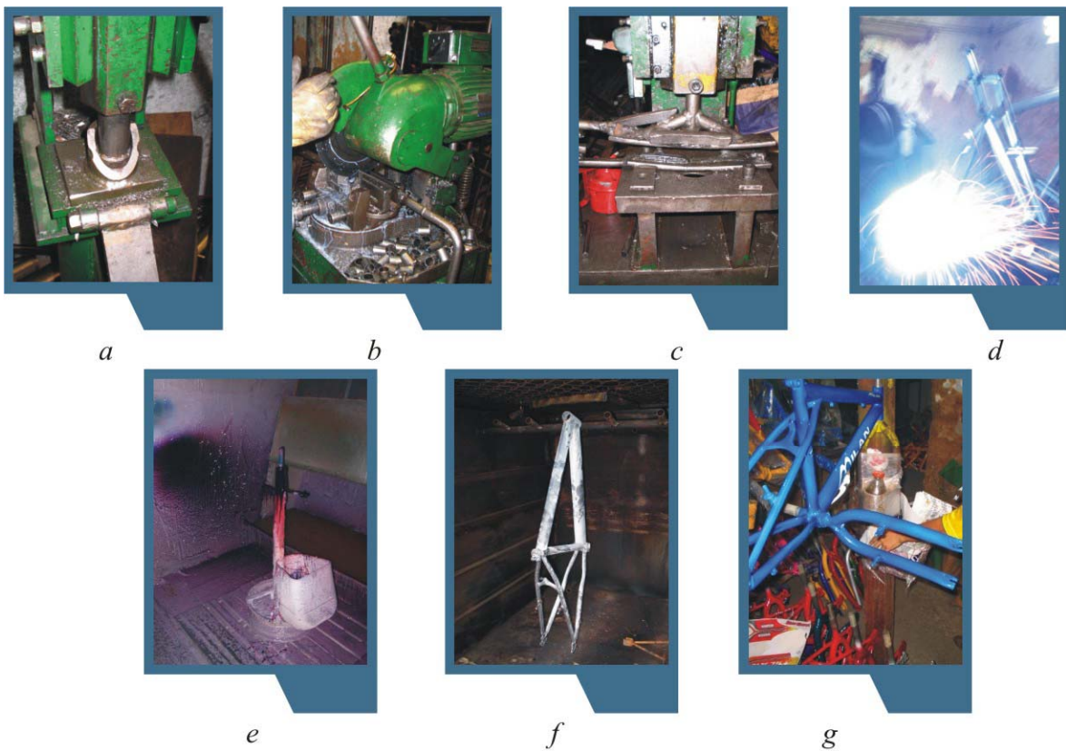
Imagen 2.17 proceso de fabricación gama baja a) aboquillado b) corte c) troquelado d) aplicacion de soldaduras e) pintura f) horneado g) decorado
