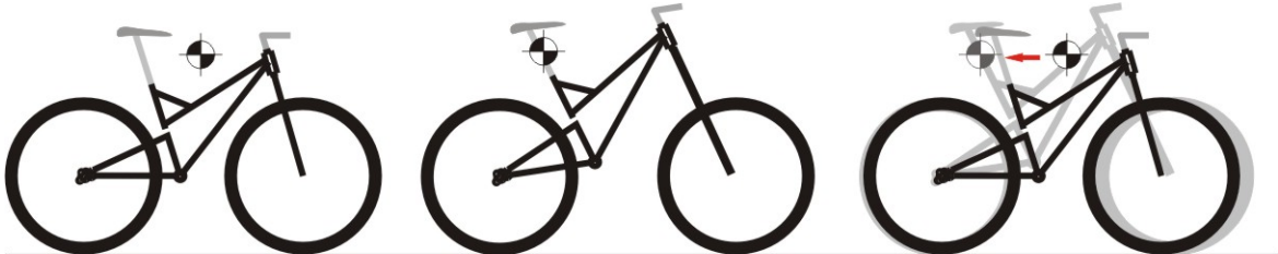
Imagen 2.39 longitud de la horquilla
