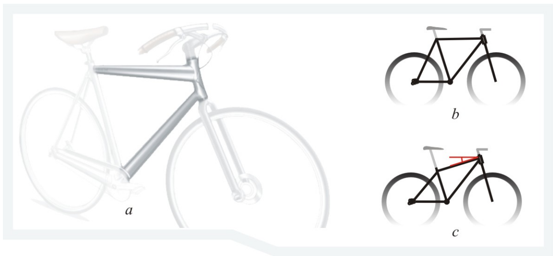
Imagen 4.1 modulo frontal a) triangulo delantero b) tubo superior recto c) angulo tubo superior
