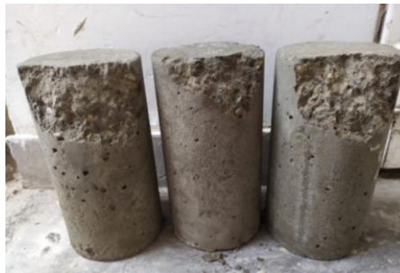
Ilustración 11: Tipo de falla en Probetas de Compresión
