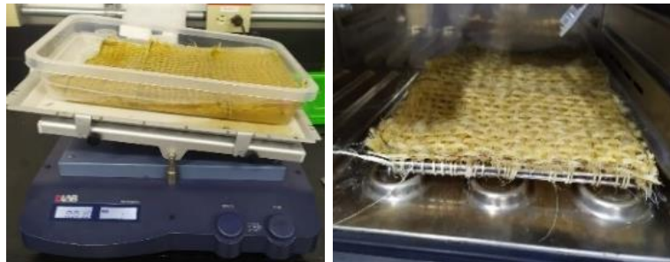
Ilustración 4: Tratamiento Alcalino a Mallas de Fique
