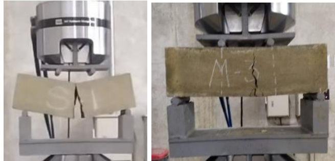
Ilustración 14: Fallas Probetas tipo Viga S y M
