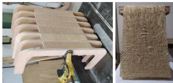
Ilustración 6: Elaboración de Formaletas y Rigidización de las mallas de fique con resina epóxica
