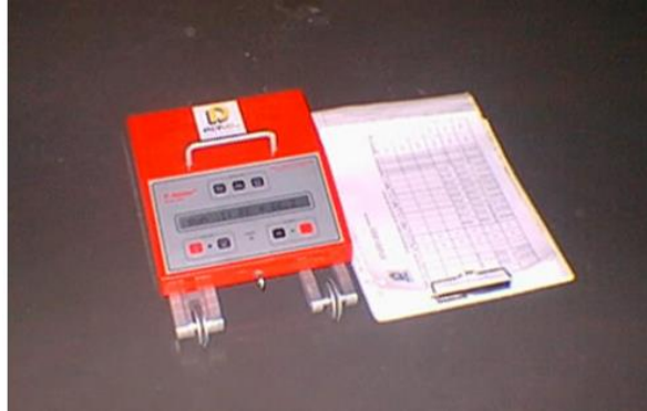
Figura 12. Dispositivo perfilógrafo de medición de regularidad
