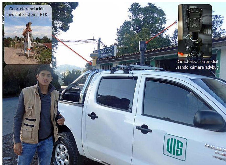
Figura 17. Equipo completo para la caracterización predial, en la Figura se observa el sistema RTK y la cámara Ladybug sobre la camioneta del grupo de investigación Geomática
