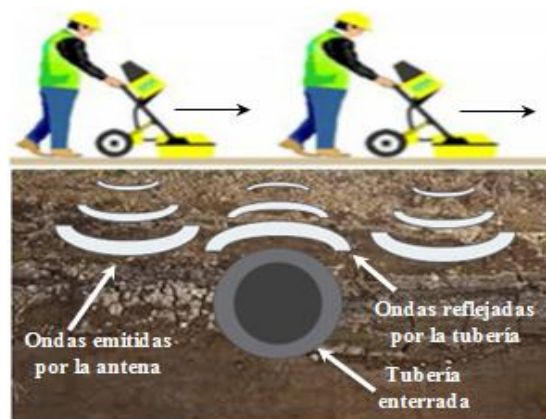
Figura 2 Funcionamiento del GPR en la ubicación de tuberías.
