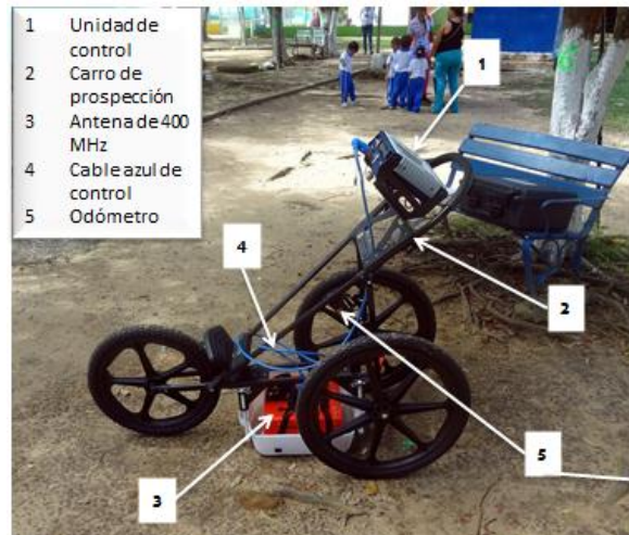
Figura 1 Radar de penetración terrestre (GPR) con cada una de sus partes.
