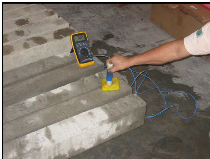
Fotografía 23. Lectura del potencial de corrosión del refuerzo de acero, empleando el electrodo de \text{Cu}/\text{CuSO}_4 como referencia.
