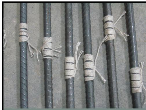
Fotografía 4. Marcaje de las varillas.
