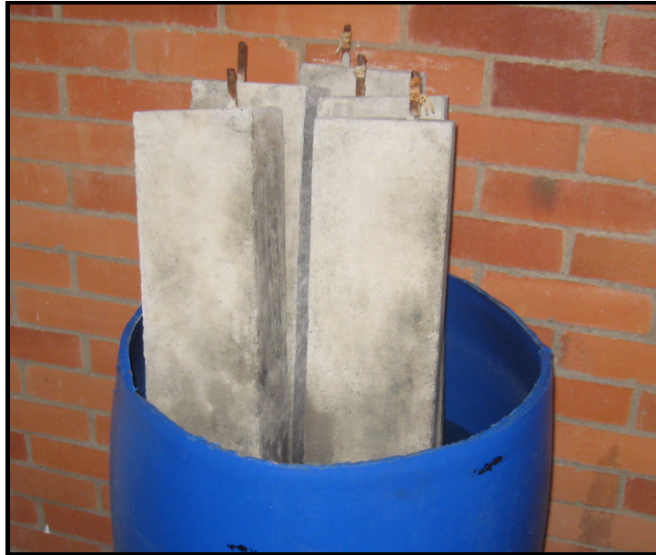
Fotografía 19. Vigas contaminadas cuatro meses de exposición.
