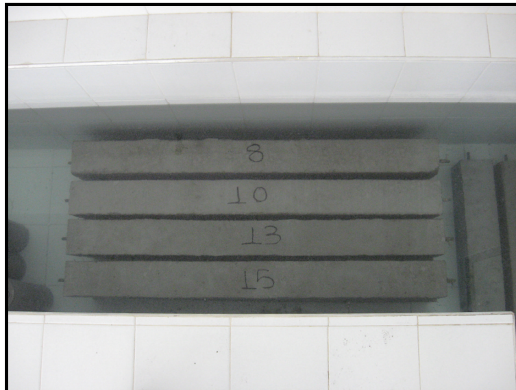
Fotografía 13. Curado de vigas vista superior.
