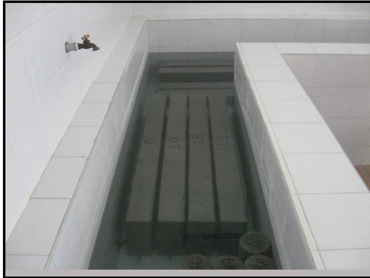
Fotografía 12. Curado de vigas vista frontal.
