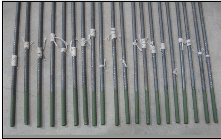
Fotografía 9. Varillas protegidas con el recubrimiento.
