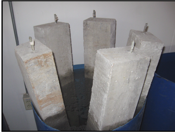
Fotografía 17. Vigas contaminadas inicio de exposición.
