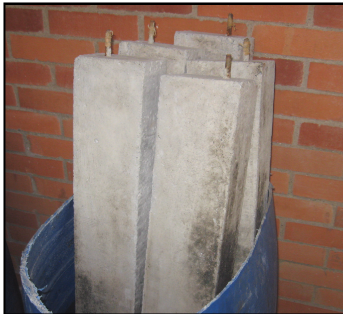
Fotografía 22. Vigas testigos cuatro meses de exposición.
