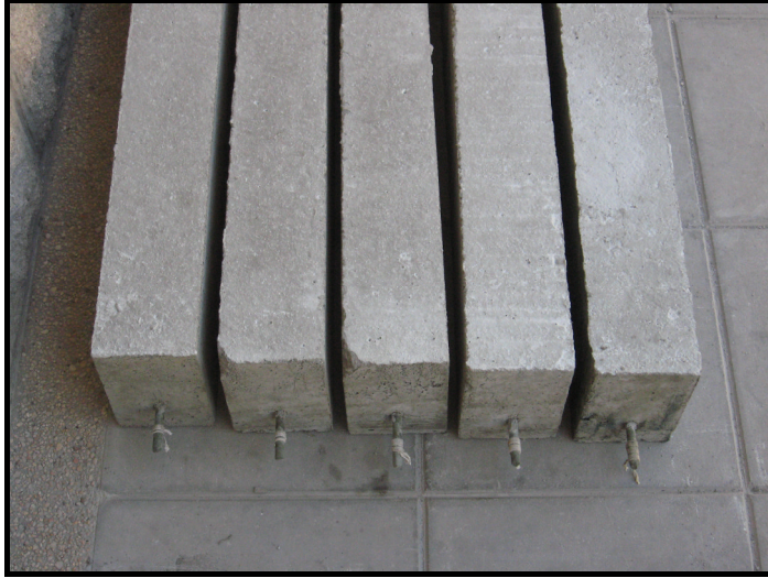
Fotografía 1. Vigas de concreto vista frontal y superior.
