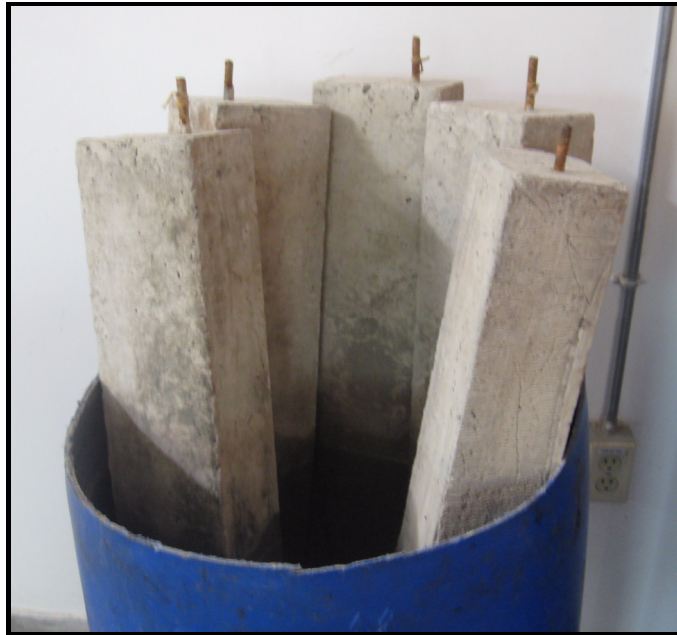
Fotografía 21. Vigas testigos dos meses de exposición.
