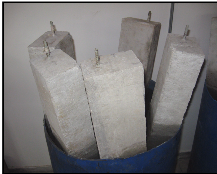
Fotografía 20. Vigas testigos inicio de exposición.
