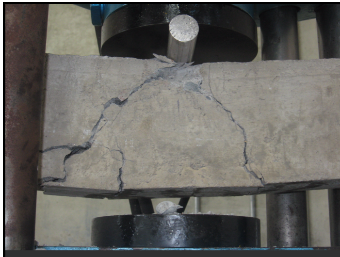
Fotografía 28. Tendencia de la falla vigas contaminadas.
