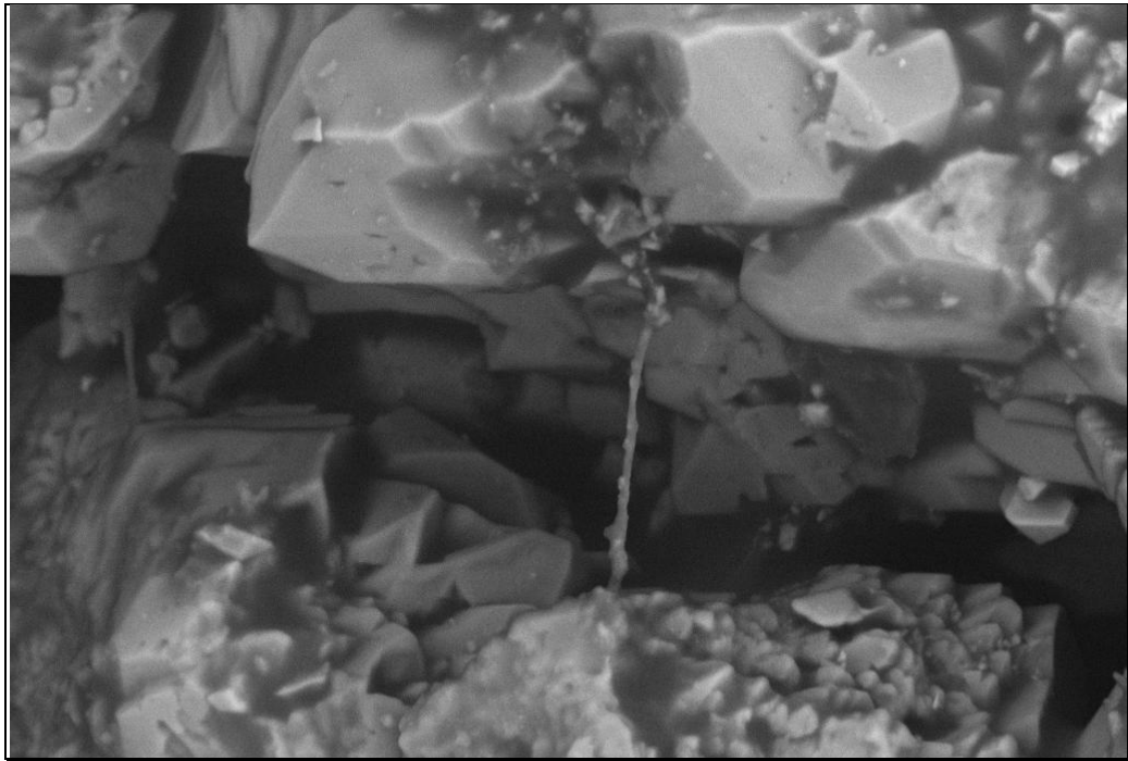
Figura 90. Material presente entre los granos del plug
