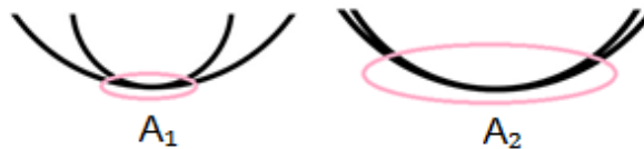
Figura 4: Área de contacto casing drilling (derecha) y drill pipe (izquierda)
