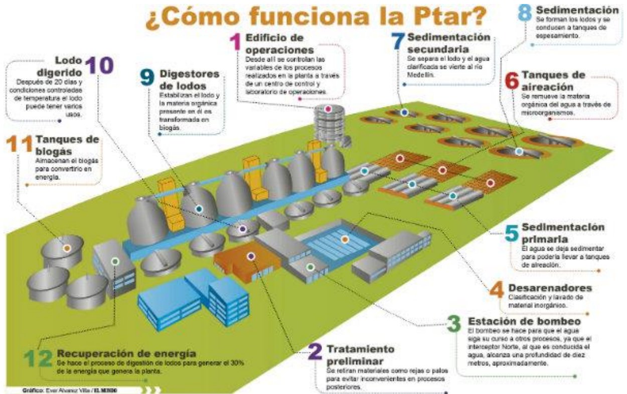
Ilustración 3, Diagrama de proceso PTAR Río Frio después de modernización. Fuente: EMPAS S.A. E.S.P.
