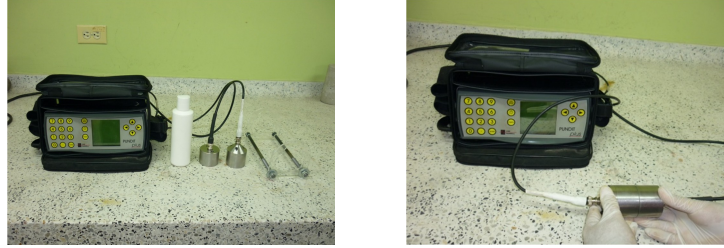
Equipo de ultrasonido MODEL PC 1006 tipo PUNDIT PLUS marca CNS FARNELL LTDA y Calibración de la unidad.
