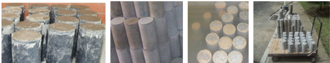
Figura 10. Fraguado, Desencofrado, Curado y Secado al Aire
