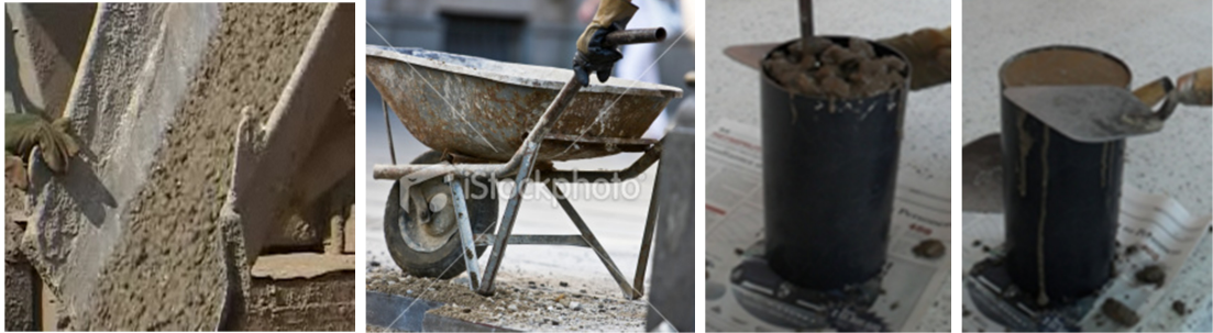
Figura 9. Proceso de Fabricación de Especímenes Cilíndricos (10x20 cm).
