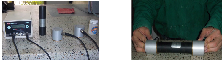
Equipo de ultrasonido MODEL 58-E0048 Tipo UPV E48 marca Controls y Calibración de la unidad.
