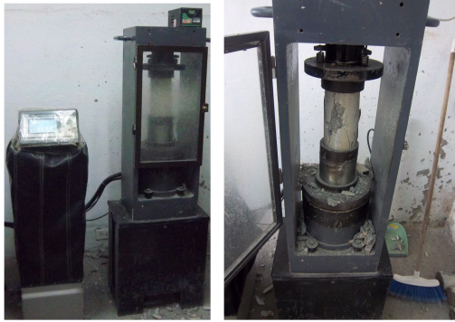
Figura 16. Máquina universal de ensayos MODEL CT-1500 tipo AUTOMAX System marca DIRIMPEX LTDA
