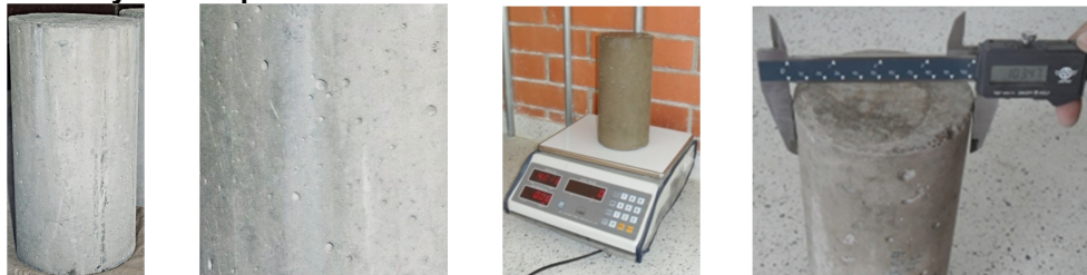
Figura 11. Ensayo de Inspección Visual
