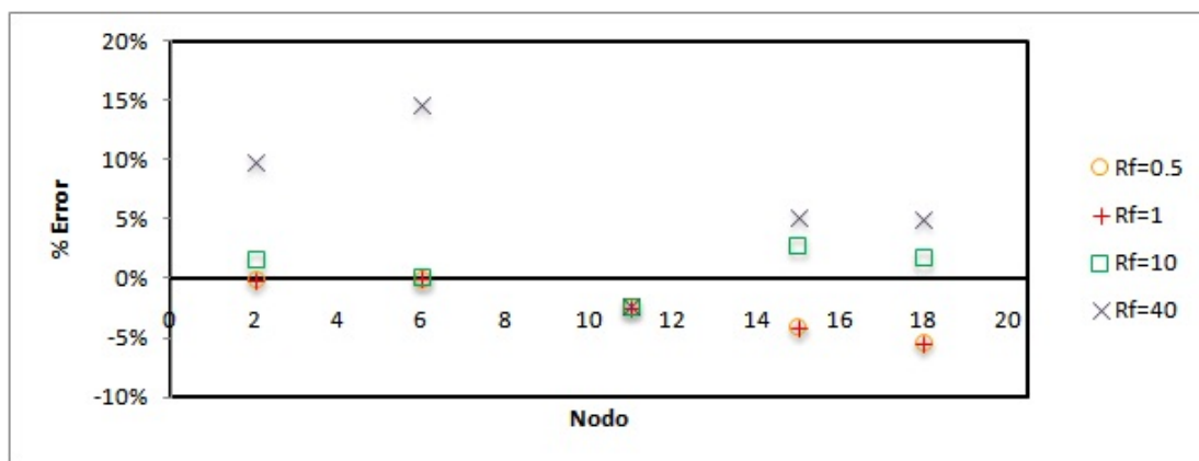
FIGURA 3.2.: Fallas monofásicas validación herramienta MBM-SC1
