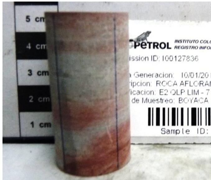
Imagen 17. PLUG con las geometrías ideal para ensayar (Lutita 2).
