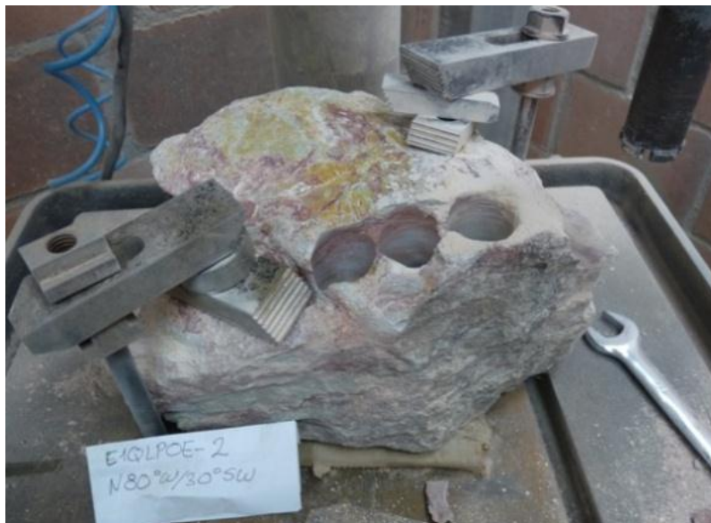
Imagen 8. Montaje de la lutita en la mesa del taladro para la extracción de los PLUG. (Lutita 2)
