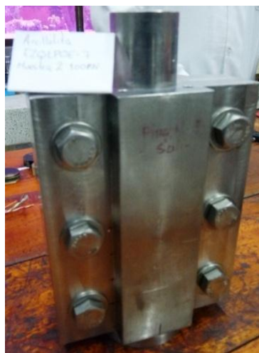
Imagen 10. Celda de Carga de consolidación armada.
