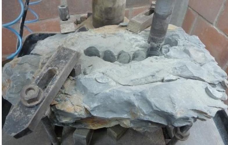
Imagen 7. Montaje de la lutita en la mesa del taladro para la extracción de los PLUG. (Lutita 1)
