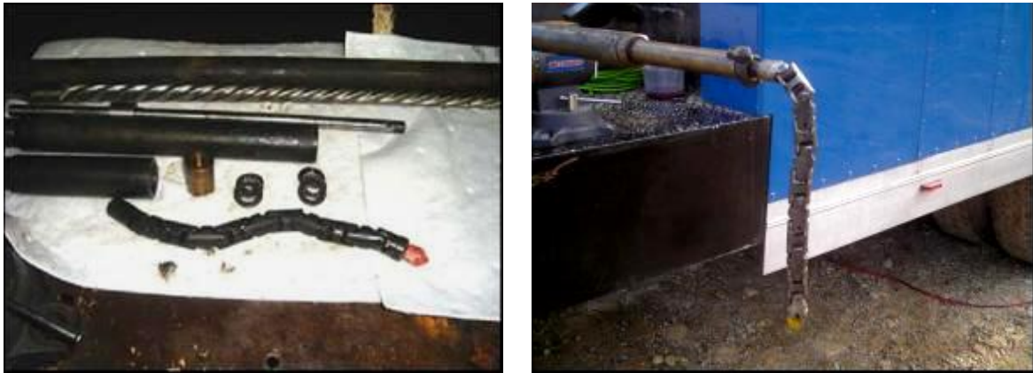
Figura 11. Unión Articulada - Cortador de Tubería.
