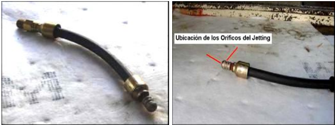
Figura 12. Jetting con manguera de Alta Presión Kevlar.
