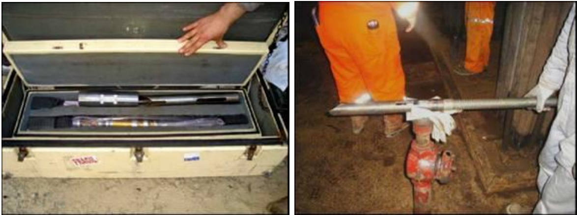
Figura 9. Herramienta Orientadora GIRO.
