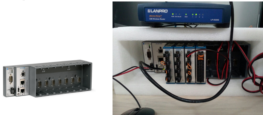
Figura 7: Representación del sistema de adquisición. Fuente, a) Sistema cRIO 9067 NI y b) módulos acoplados al chasis del cRio.
