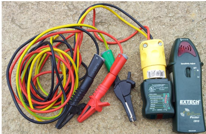
Figura 11. Extech CB10. Buscador de interruptores de circuito y probador de enchufes.
