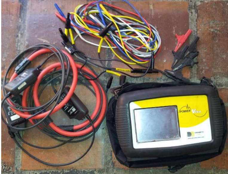
Figura 6. Analizador de redes Dranetz-BMI PowerVisa™.
