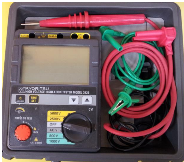
Figura 9. Medidor de resistencia de aislamiento kyoritsu 3125.
