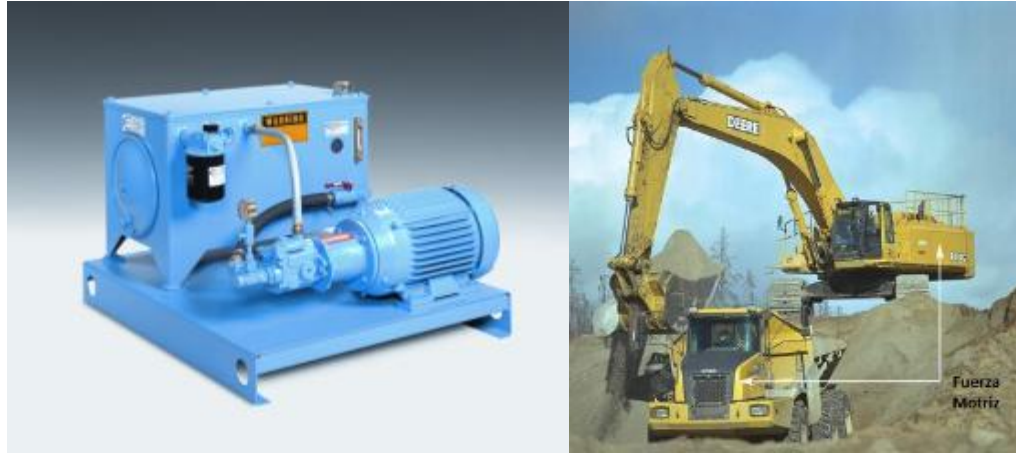
Figura 52. El motor primario para grupos hidráulicos son típicamente motores eléctricos en las instalaciones de fabricación (A) y los motores de combustión interna en equipo móvil (B) (hidráulicas Continental; Deere & Co.)
