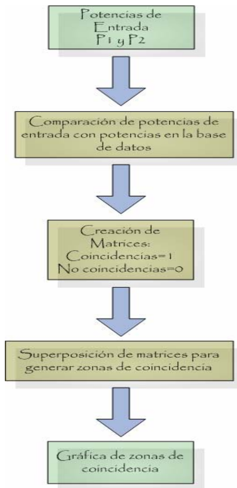
Figura 12. Diagrama de bloques del algoritmo de búsqueda
