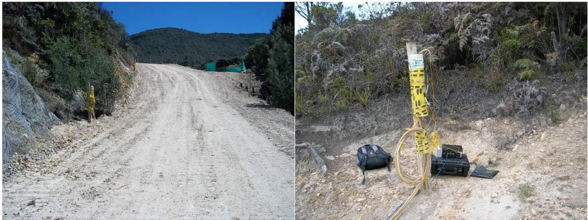
Las condiciones donde está instalado el sensor FBG del PK 216+000 se muestran en la figura No.11., con los respectivos esquemas de las fuerzas a las cuales está sometida la tubería.
