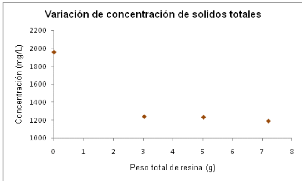
Figura 9. Variación de concentración de sólidos totales presentes en la muestra de DAM mina Boyacá post-tratamiento
