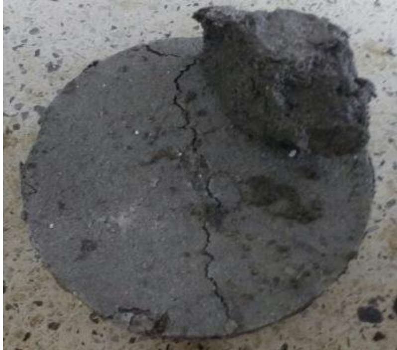
Figura 3. Probeta con adición de 9% de jugo de fique 24 horas después de la inmersión.
