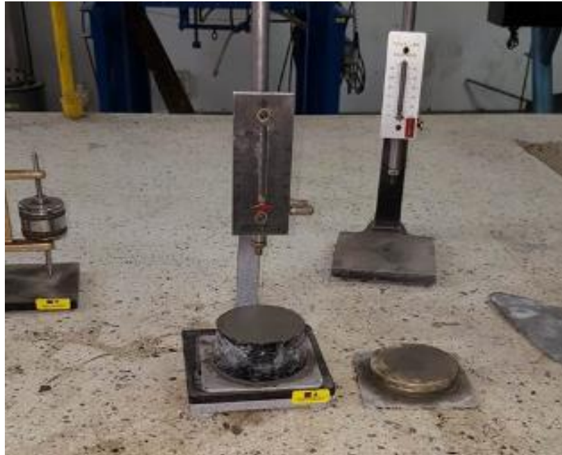
Figura 5. Ensayo de tiempos de fraguado por el método de Vicat.
