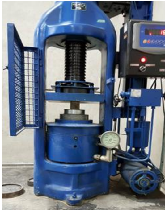
Figura 6. Imposición de la carga axial de compresión sobre el espécimen de mortero.
