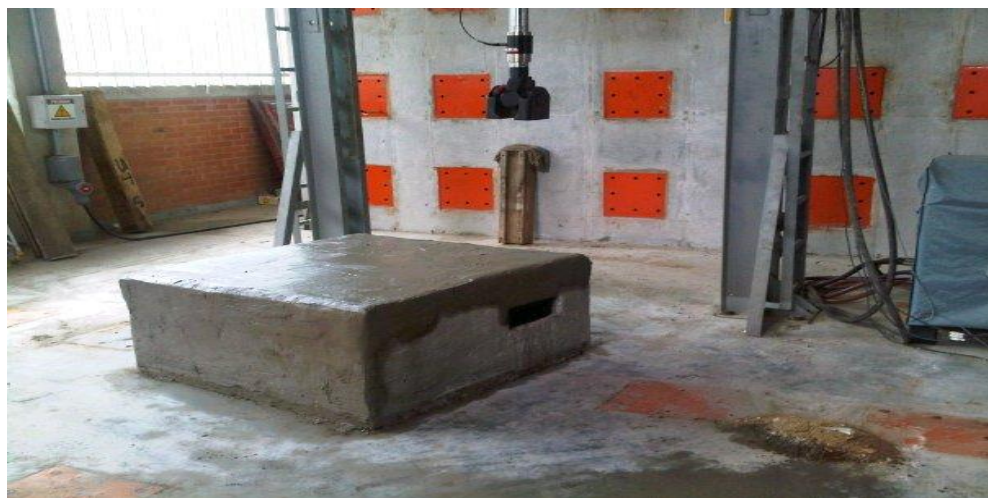
Foto 36: Curado por 28 días del modelo a escala terminado.
