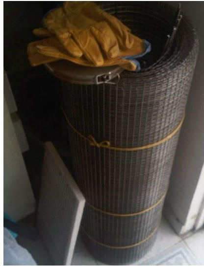
Foto 18: Malla de refuerzo – Muros
