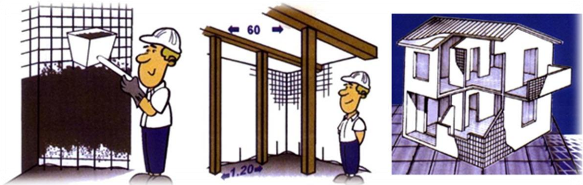
Figura 9: Montaje de paneles de placa, cerramiento de la estructura, lanzamiento del concreto y acabados de la superficie.
