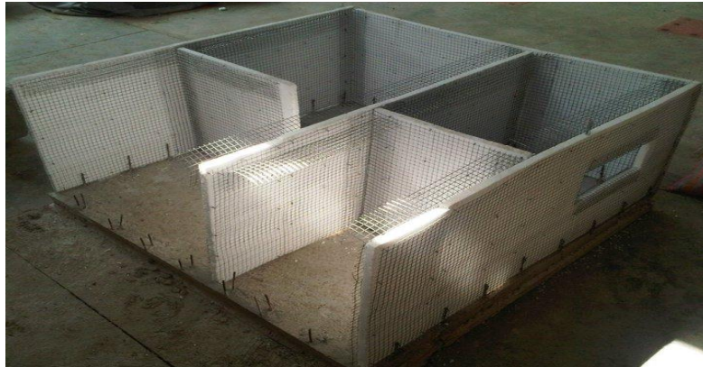
Foto 27: Refuerzo en marcos de ventanas y puertas
