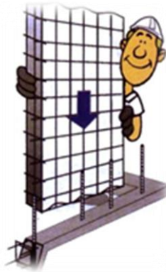
Figura 6: Colocación de los paneles verticales de pared.
