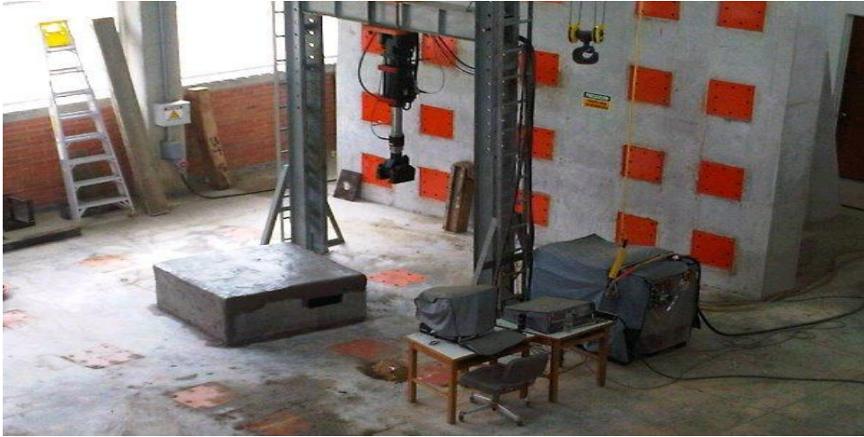
Foto 37: Panorámica del modelo a escala en proceso de curado.
