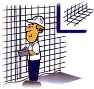
Figura 7: Colocación de instalaciones y refuerzo de unión entre paneles
