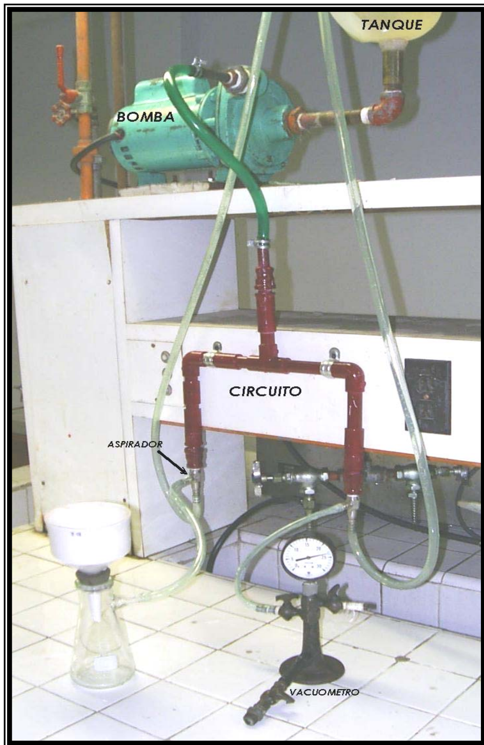
Figura 5. Prototipo del sistema de filtración al vacío con recirculación de agua
