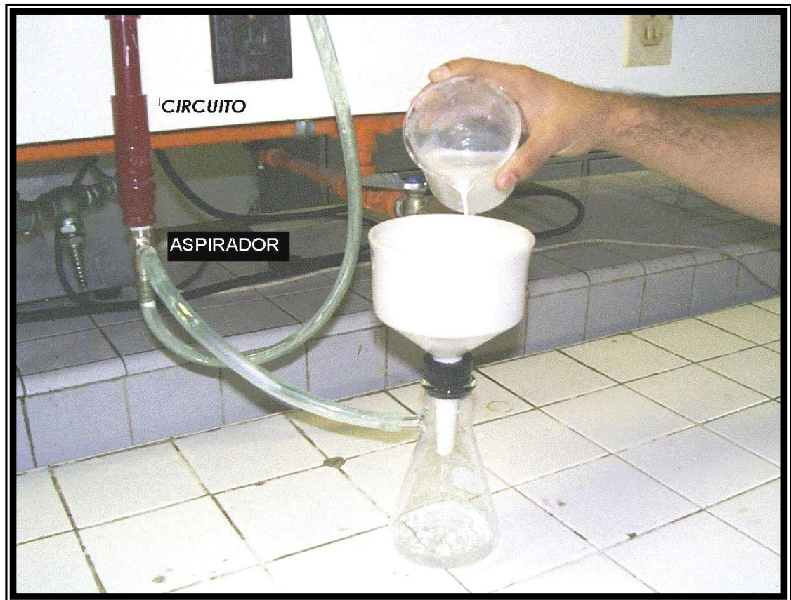
Figura 9. Filtración de una solución sobresaturada por medio del prototipo con recirculación.
