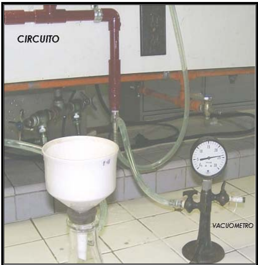
Figura 6. Vacío generado por el prototipo
