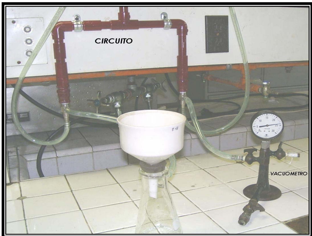
Figura 12. Medida de la succión en el prototipo
