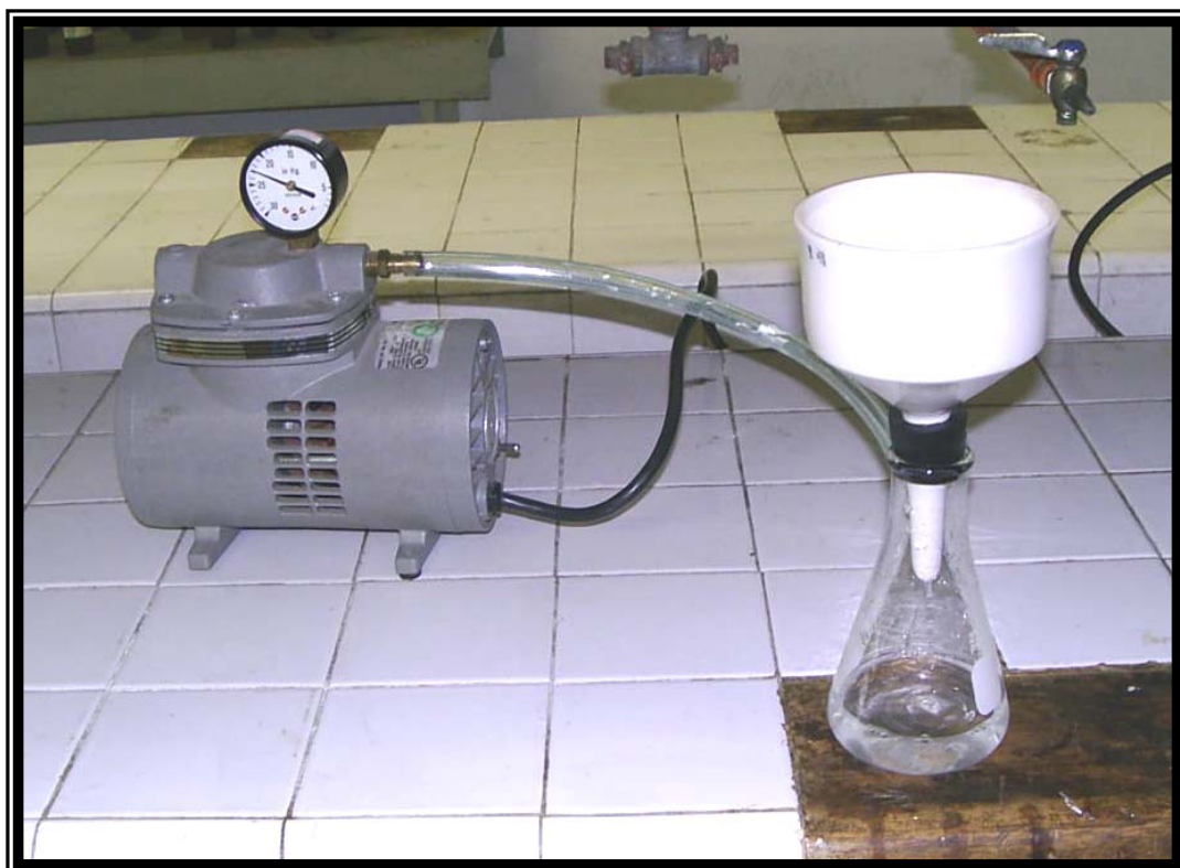
Figura 7. Filtración de una solución sobresaturada por medio de bomba de vacío
