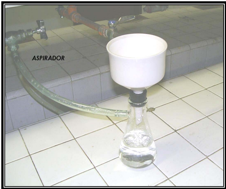
Figura 8. Filtración de una solución sobresaturada por medio de del método convencional.
