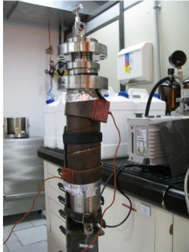
Figura 4. Calentamiento previo del cilindro para agitación manual.
