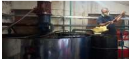
Figura 13. Mezcla final para obtención de grasa
