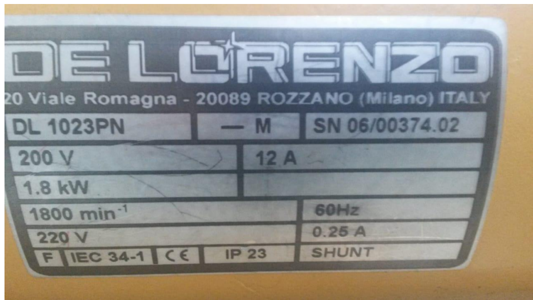
Figura 5. Datos nominales de la máquina DC marca De Lorenzo
