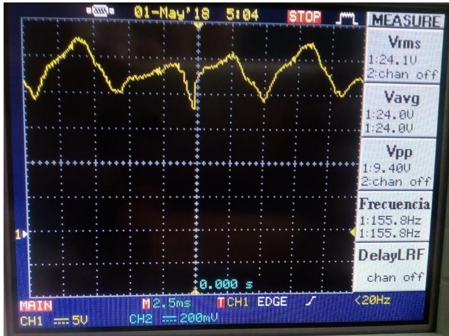
Figura 50. Tensión de salida de la fuente DC a la entrada del troceador.
