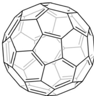
Figura 35. Estructura molecular del fullereno C_{60} . 61
