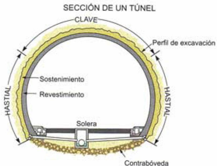
Figura 1. Estructura de un túnel
