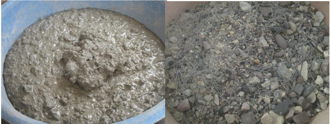
Figura 22. Muestra de concreto antes y después de ser lavada.
