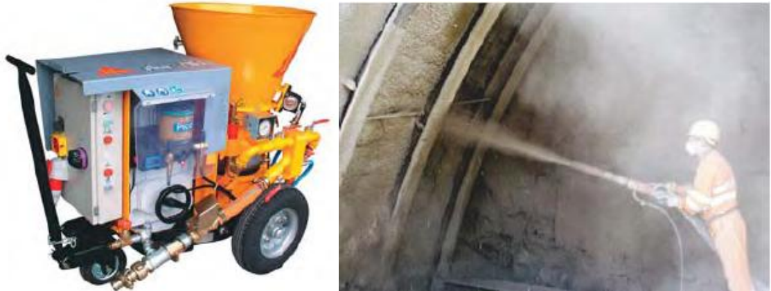
Figura 16. Equipo para lanzado de concreto vía seca.
