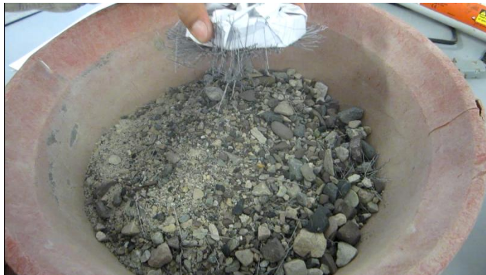
Figura 23. Extracción de fibra metálica.
