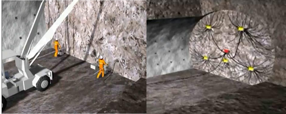
Figura 5. Instalación de explosivos
