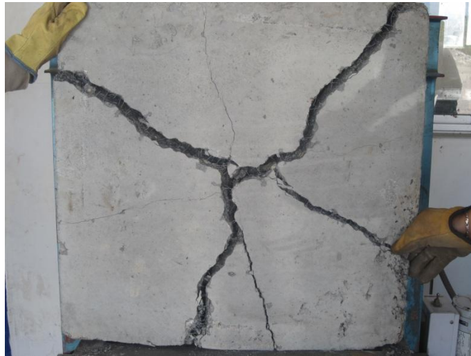
Figura 21. Panel de concreto después del ensayo de absorción de energía.
