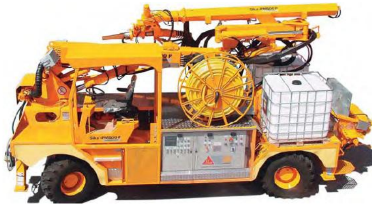
Figura 13. Equipo para lanzado de concreto vía húmeda.
