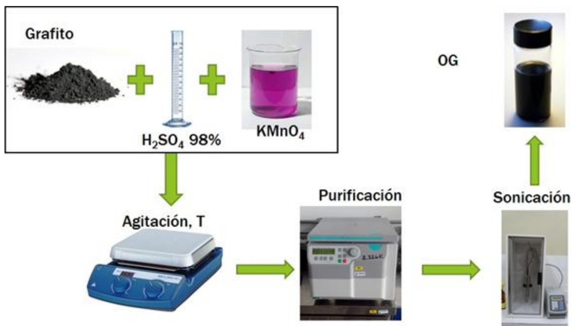
Figura 3. Procedimiento de la síntesis del OG.
