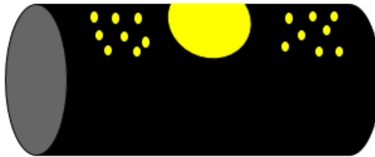
Figura 14. Diagrama de régimen burbuja en tubería horizontal.
