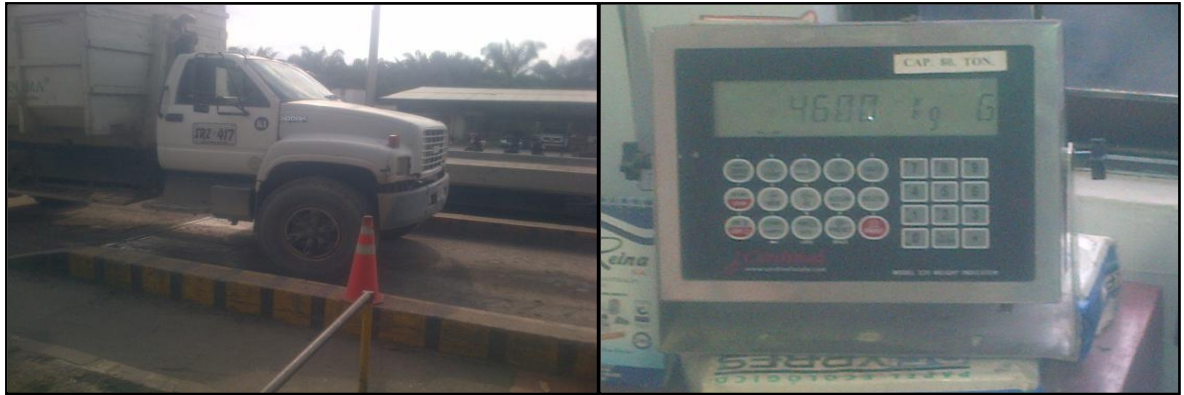
Figura 11. Sobre un extremo de la báscula se pone el eje delantero del vehículo y se toma inmediatamente el registro del peso.
