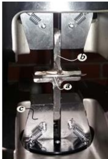
Figura 34. Montaje para pruebas en dirección radial.
