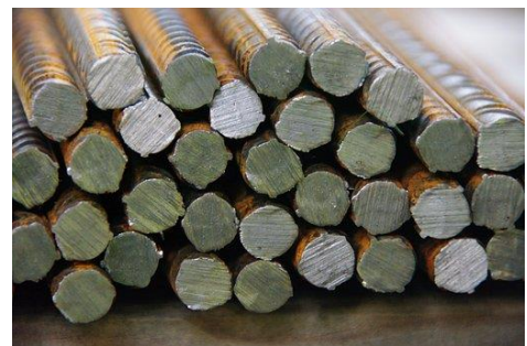
Figura 5. Barras de metal (Isótropo)
