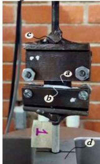
Figura 33. Montaje para pruebas en la dirección tangencial
