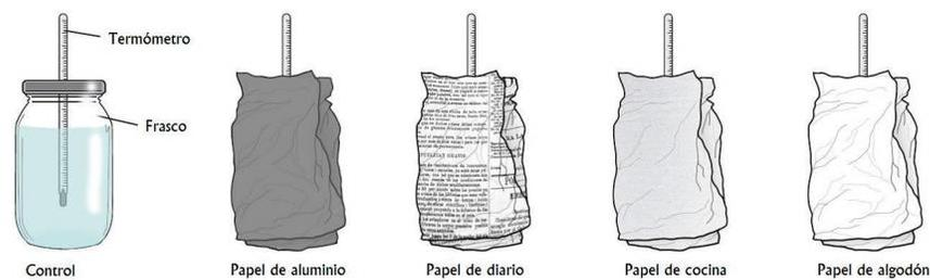
A cada uno de los frascos le pusimos la misma cantidad de agua a 92° C. Medimos y registramos la temperatura del agua en cada frasco después de 10 minutos.
