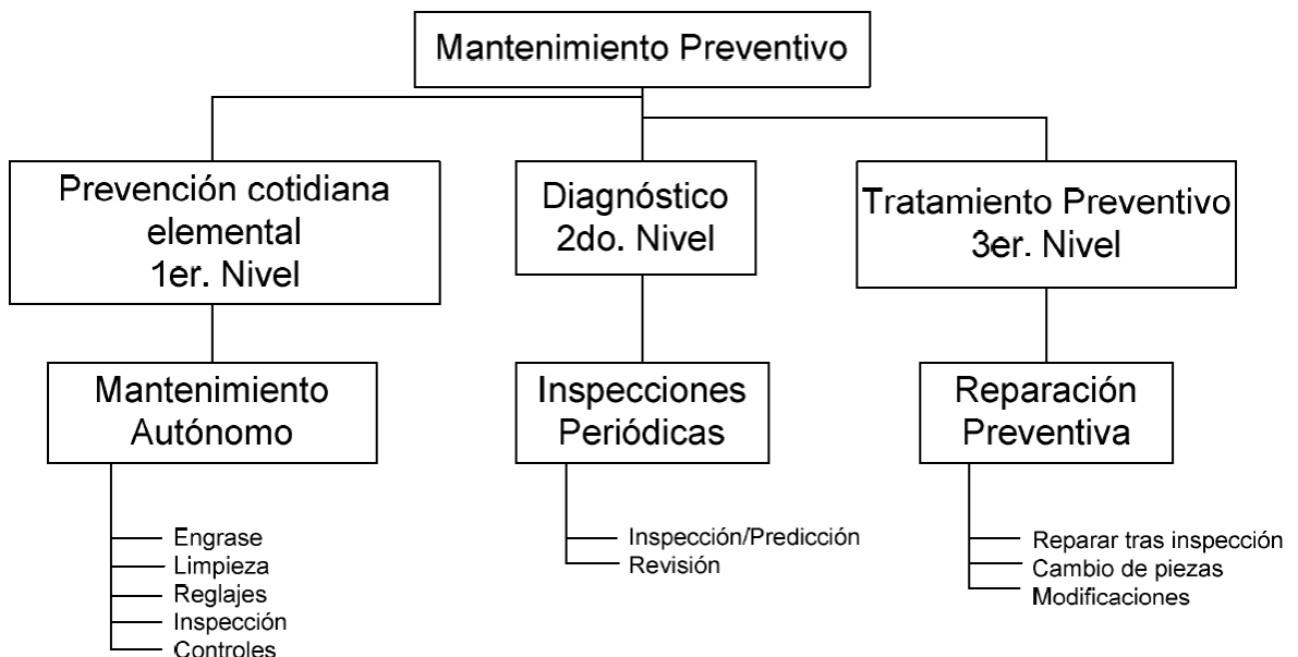
Figura 24. Mantenimiento programado – preventivo.
