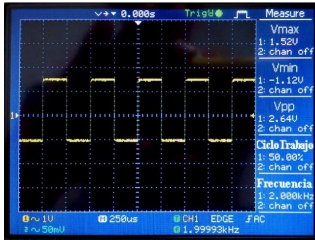
Figura 72. Señal PWM generada por medio de la Toolbox <Electric Motor Control Blockset>
