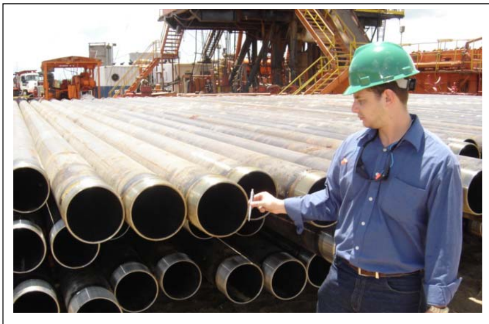
Figura 16. Casing 9-5/8", 47#/ft, BTC R3 utilizado en Caño Limón.
