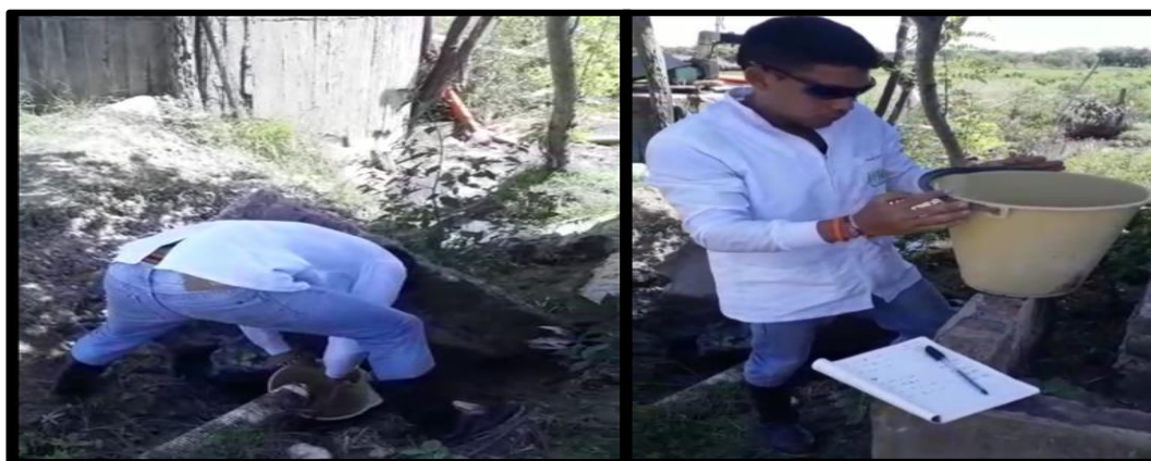
Figura A. 1. Registro fotográfico de la medición del caudal en el Punto de vertimiento
