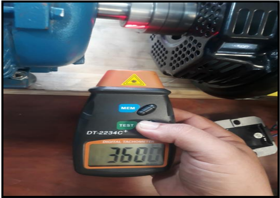
Figura 36. Medición de velocidad del motor eléctrico.
