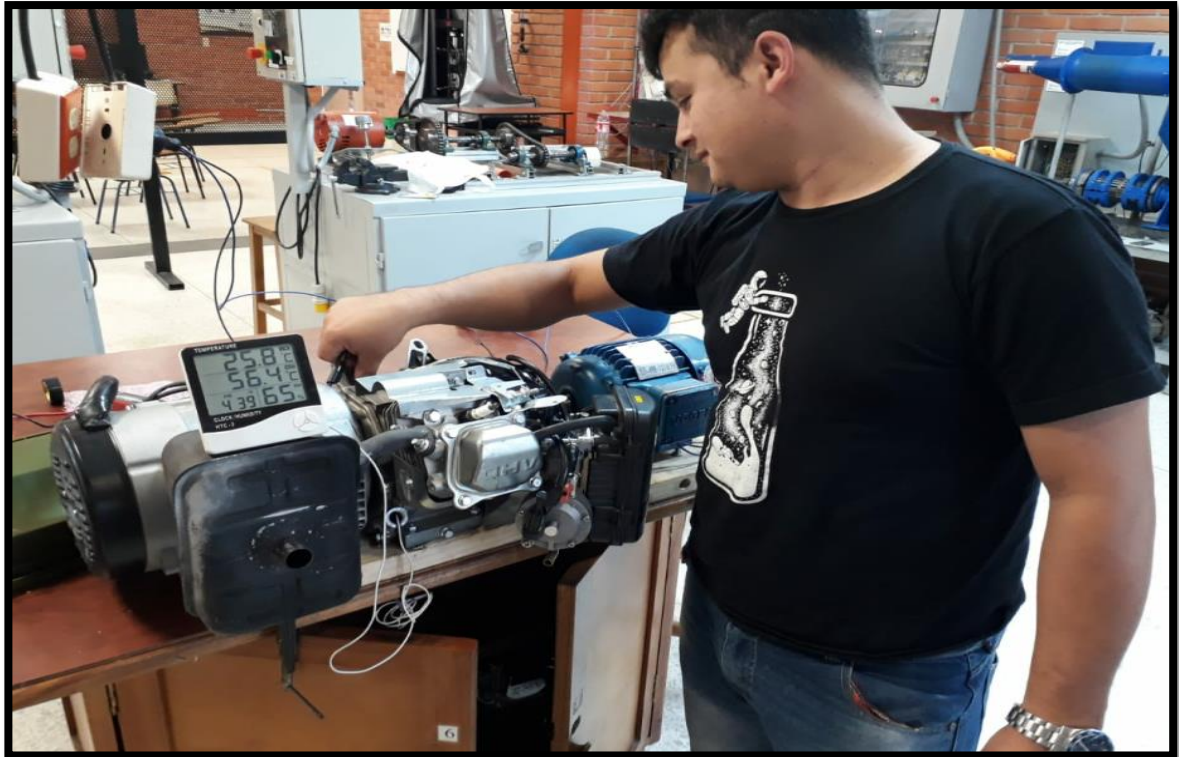
Figura 35. Medición de la temperatura del aceite lubricante.
