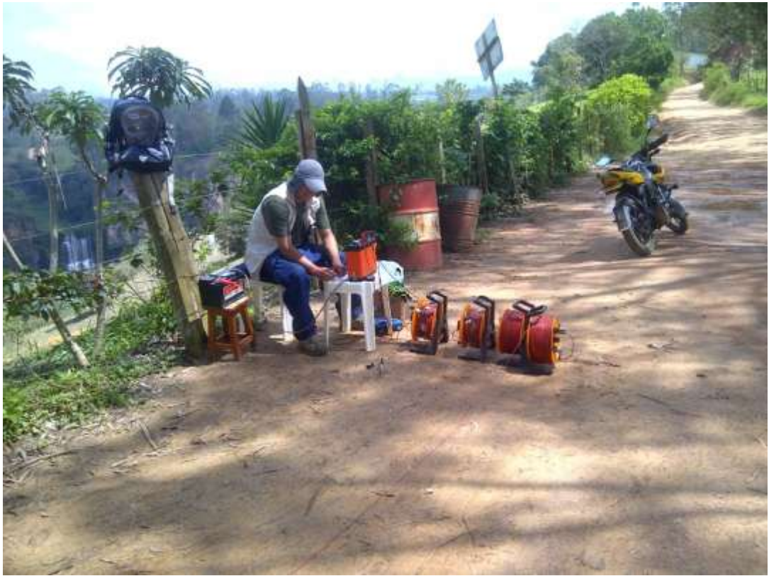
Figura 17. Montaje inicial y disposición del equipo central y los carretes.
