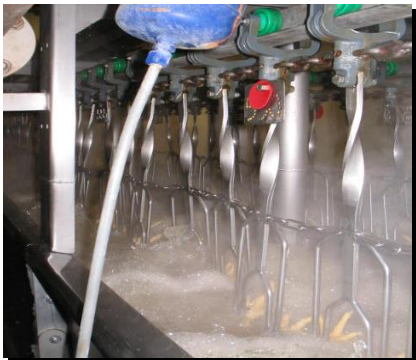
Escaldado a temperatura de 56 – 57°C , por un tiempo de 41 segundos.
