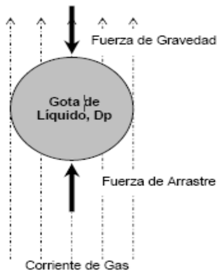
Figura 14. Fuerzas que actúan sobre una gota de líquido que cae contra una corriente de gas.
