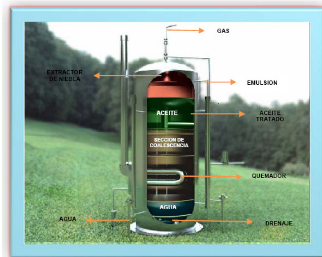
Figura 22. Tratador Térmico Vertical
