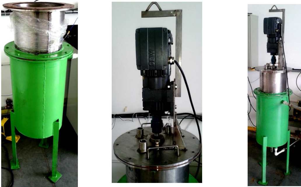
Figura 33. Fotografias del biorreactor construido. tanque y motor
