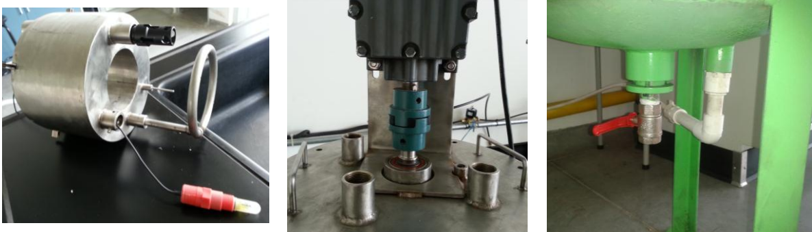
Figura 34. Fotografias del biorreactor construido. Canasta, acople y drenaje
