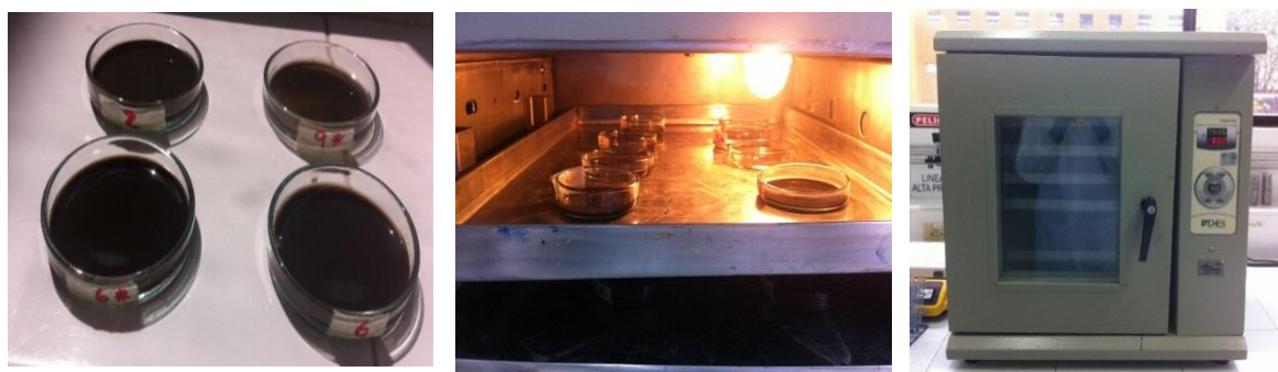
Figura 35. Muestras dispuestas en cajas Petri para llevar al horno.
