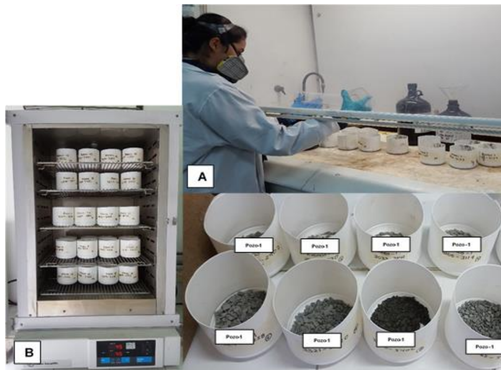
Figura 29. Proceso de lavado (A) y secado (B) de las muestras seleccionadas del Pozo-1.
