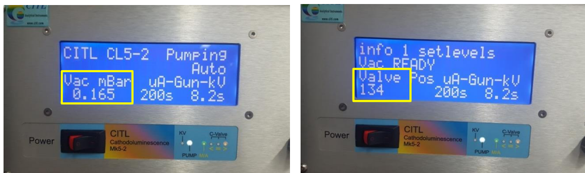
Figura 39. Condiciones requeridas de vacío y de la válvula para poder accionar el switch kV.
