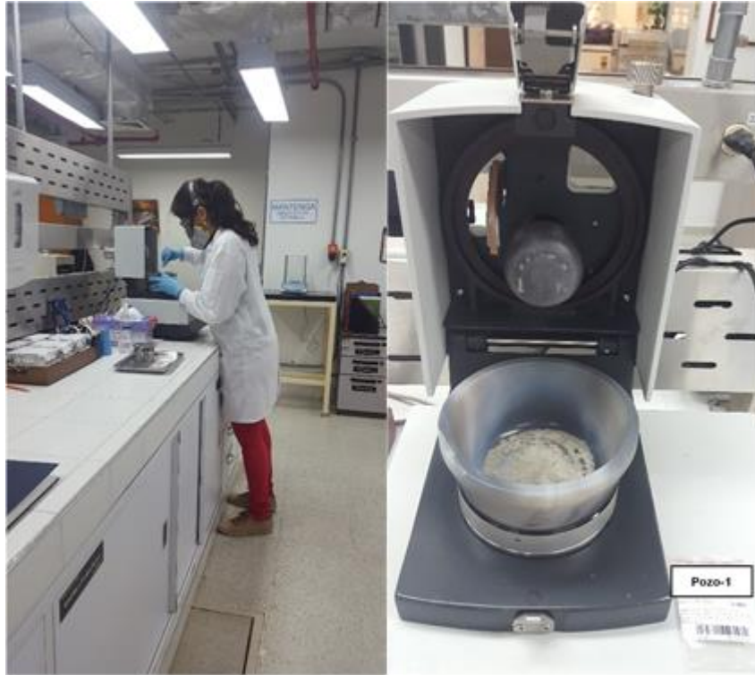
Figura 31. Proceso de pulverizado de las muestras seleccionadas del Pozo-1.
