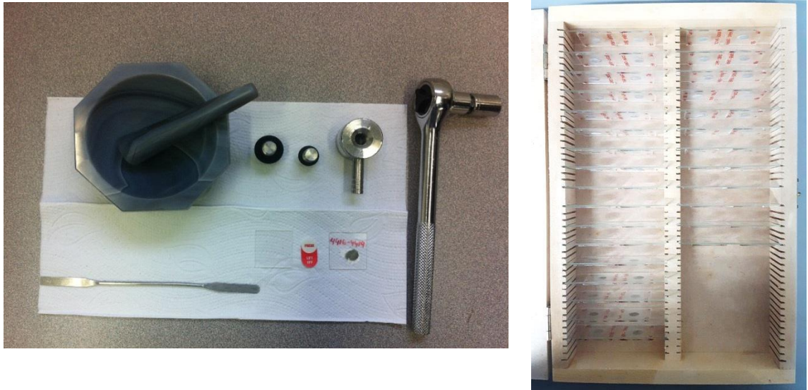
Figura 36. Instrumentación para la elaboración de las pastillas y su respectivo almacenamiento.
