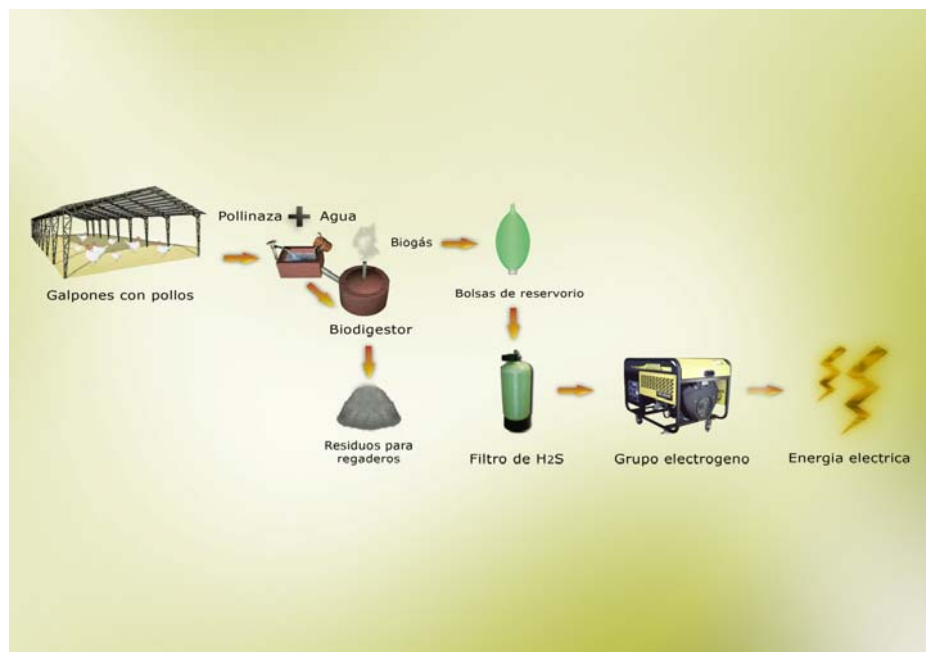
Figura 14. Proceso de generación de energía eléctrica a partir de pollinaza.
