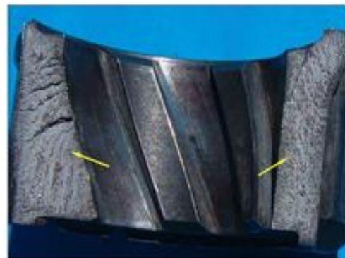
Foto 3. Superficies de fractura súbita frágil del piñón.
