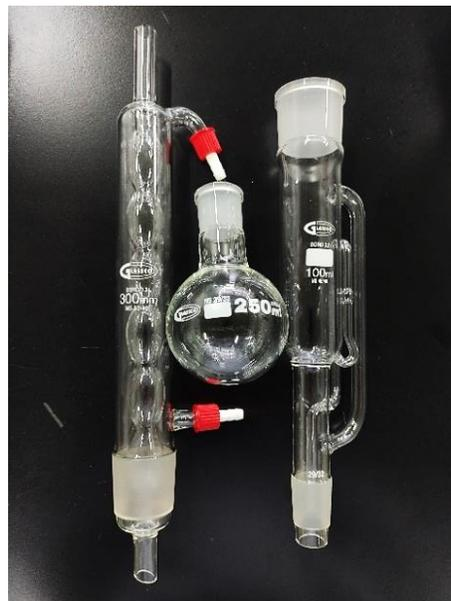
En la figura 2 se observa de izquierda a derecha: condensador, balón y sifón Soxhlet, para completar el equipo se necesita la plancha de calentamiento que se aprecia en la figura 3 de color azul.
