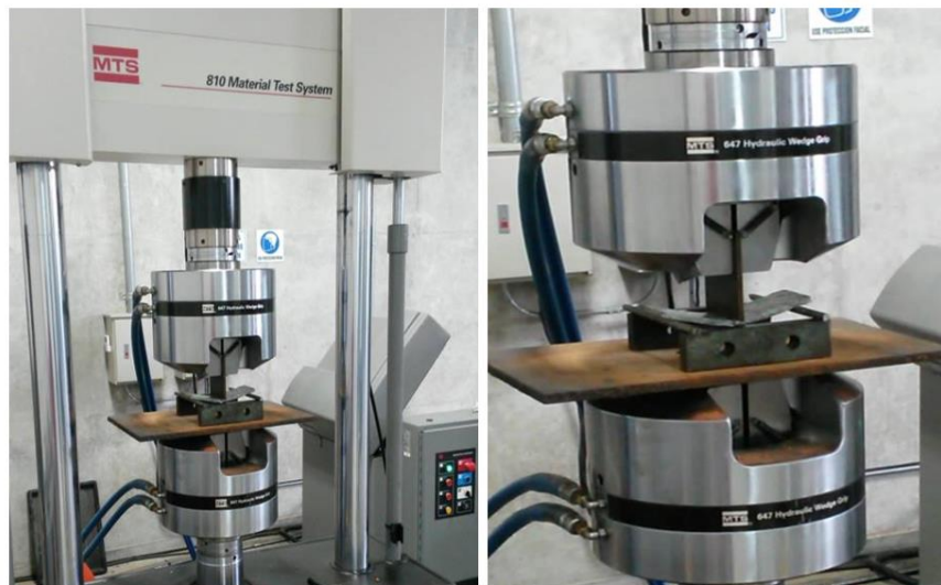
Figura 2. Prueba del módulo de rotura y elasticidad.
