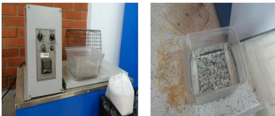
Figura 3. Prueba de absorción de agua para el tectan a 1 hora y 24 horas.
