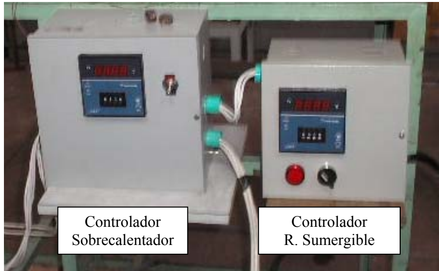
Figura 14. Sistema de control de temperatura.
