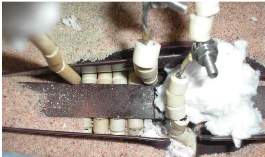
Figura 12. Resistencias eléctricas recubiertas con cerámico.
