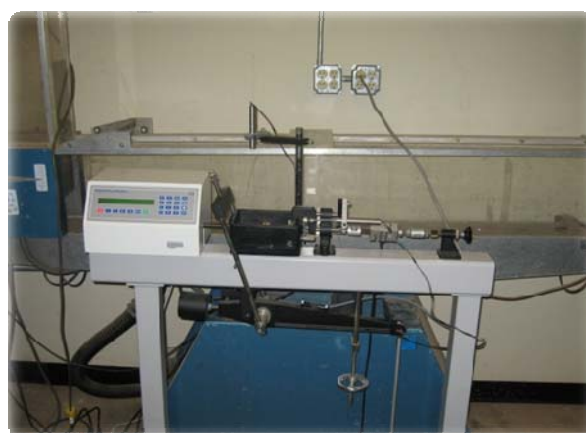
Figura 13: Máquina de corte directo y Pullout
