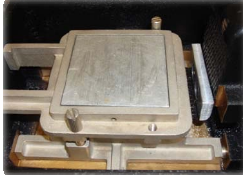
Figura 20: Muestra armada para el ensayo de Pullout.
