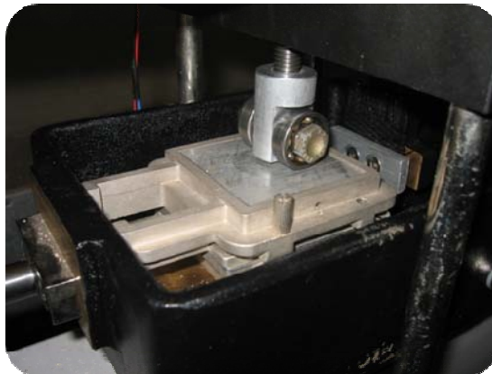
Figura 15: Modificación de la máquina de corte directo. (Pullout)
