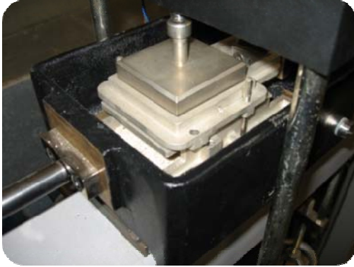
Figura 14: Caja de corte original. (Ensayo de corte directo)
